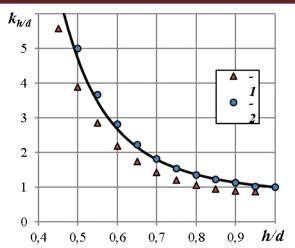
Рис. 1. Зависимость коэффициентов  $k_{h/d}$  от наполнения трубопровода h/d и влияния гидродинамических характеристик потока:
