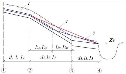
Рис. 2. Расчетная схема напорно-самотечного режима работы коллектора дождевой сети
